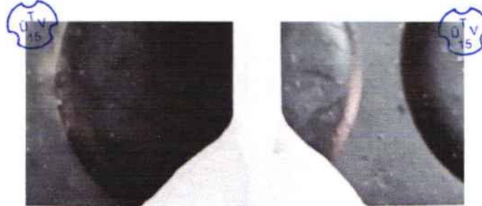
Abb. 1: Übersichtsaufnahme PB1 sl (V 3:1) Fehlerfreier Nahtaufbau und einwandfreier Wurzeleinbrand
